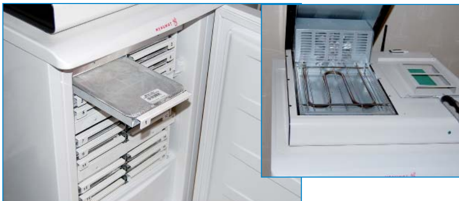
Kuvat 53–54. Ateriat toimitetaan Menu-mat-ruoka-automaattiin pakastettuina. Kuumennus tapahtuu erillisessä pienessä kiertoilmaluunissa. Toimintaohjeet tulee puhuttuna. Kuvat: Anneli Reisbacka
