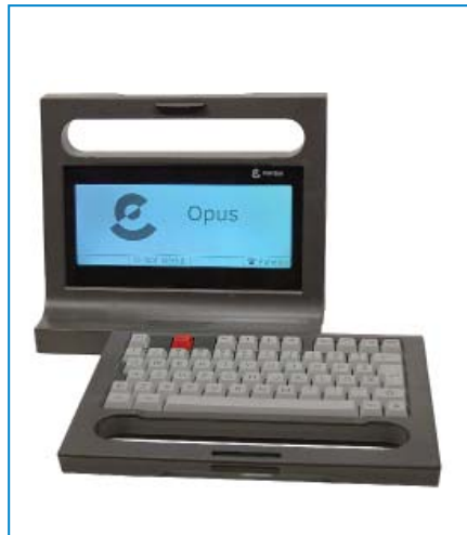
Kuva 23. Tekstipuhelin on laite, jolla voidaan korvata puhelimesta puhuminen kirjoittamalla. Se sopii henkilöille, jotka eivät pysty enää millään apuvälineillääkään puhumaan puhelimesta. Kuva: KL Support
