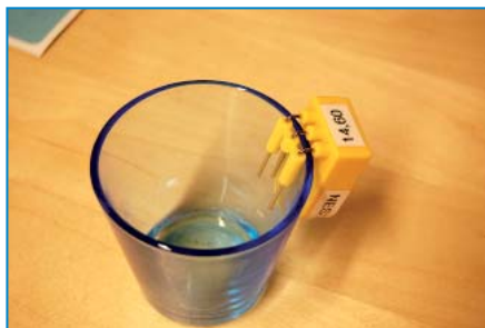
Kuva 8. Nestepinnan ilmaisin piippaa ja tärissee, kun anturit koskettavat nestepintaa. Kuva: Anneli Reisbacka
