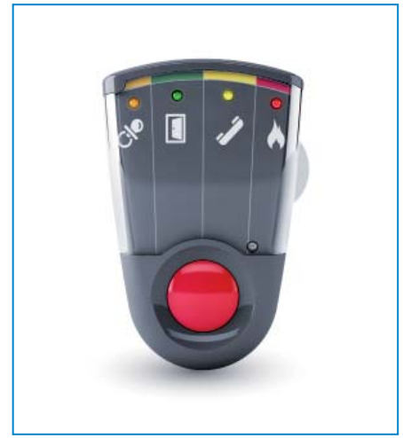
Kuva 24. Kannettavaan vastaanottimeen voidaan ohjata tarpeellisia hälytyksiä, kuten palovaroitin, ovikello, puhelin, itkuhälytintms. Kuva: Kuuloinva
