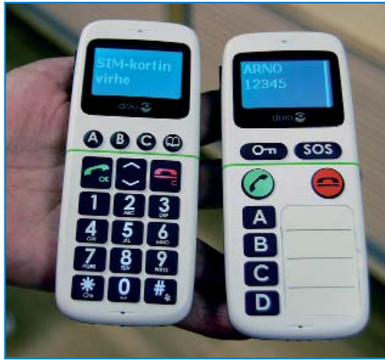
Kuva 20. Suurinumeroiset kännykät helpottavat niiden käyttöä. Niihin voidaan ohjelmoida käyttäjälle tärkeimmät numerot, jolloin valinta tapahtuu yhdellä napin painalluksella. Kuva: Anneli Reisbacka
