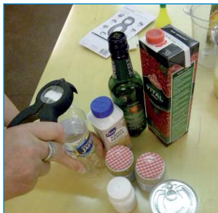
Kuva 51. 6 in 1 monitoimiavaaja soveltuu kierrekorkillisten pullojen, purkkien, rengas-säilyketölkkiä sekä kruunu- ja repäisykorkkien avaamiseen. Terää voi käyttää tyhjiöpakkauksien pussien auki leikkaamiseen. Kuva: Arja Rytkönen
