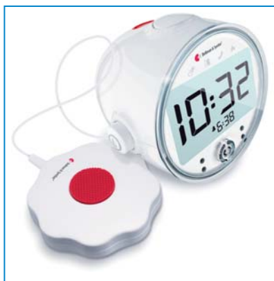
Kuva 27. Herätyskellossa olevan tärhistimen voi panna tyynyn alle. Kellon soidessa tärstin tärisee voimakkaasti ja siinä on kirkkaasti vilkkuva valo. Kelloon voidaan kytkeä esim. palvaroitimen, puhelimen ja itkuhälyttimeä hälytys. Kuva: Kuuloinva.
