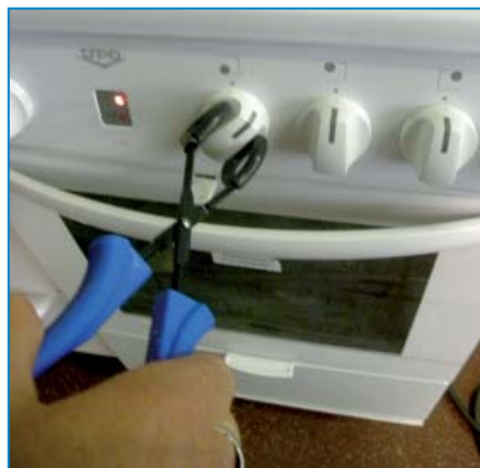
Kuvat 52. Stirex-tartuntapihtien leukojen muotoilu soveltuu esimerkiksi kodinkoneiden vääntimien käyttöön, sähköpistokkeiden irrottamiseen, astioiden siirtelyyn ym. Kuva: Arja Rytkönen
